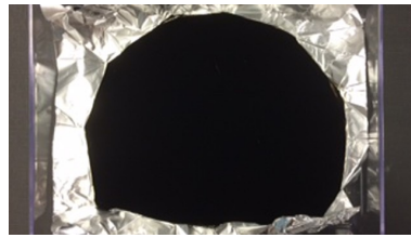
Σχήμα 1.4: Το υλικό Vantablack κατασκευασμένο από νανοσωλήνες άνθρακα ( Surrey NanoSystems ) το οποίο κατά τους κατασκευαστές απορροφά 99.96% του προσπίπτοντος σε αυτό φωτός. Εδώ επάνω σε φύλλο αργιλίου.
