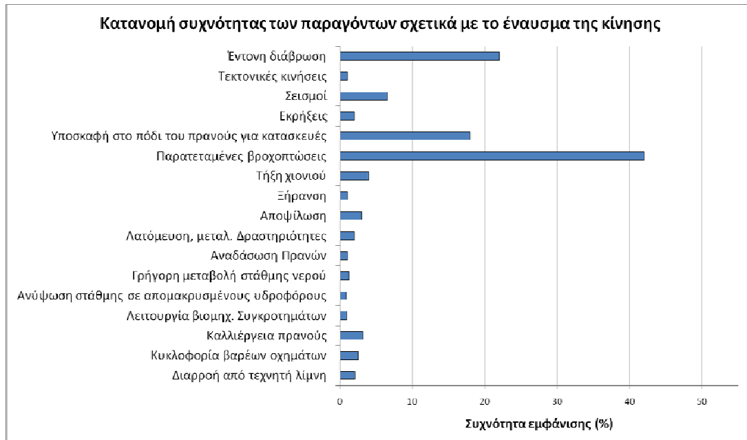
Σχήμα 2. Κατανομή συχνότητας παραγόντων σχετικά με το έναυσμα της κατολισθητικής κίνησης (Κούκης & Ζιούρκας 1989 τροποποιημένο).
